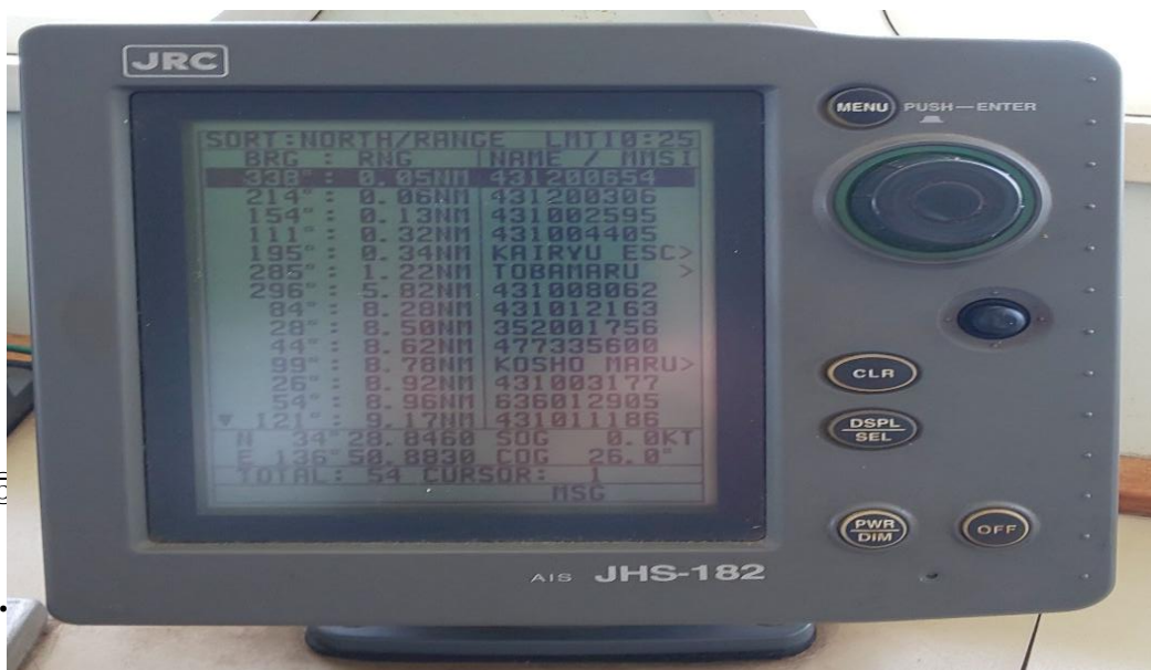
④ 非常用位置発信装置 AIS（船舶自動識別装置）
